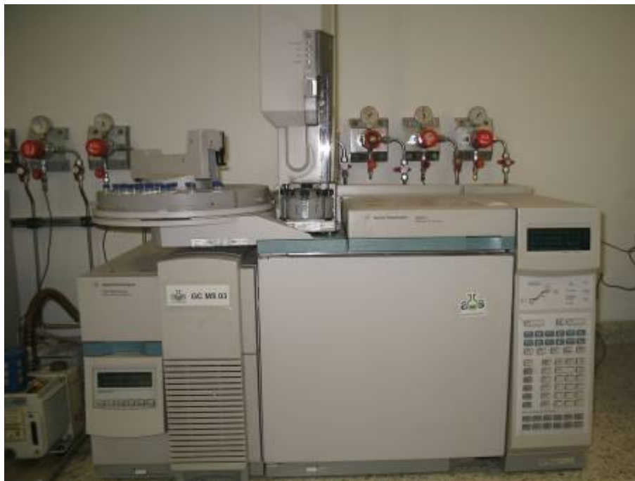
Figura 04: Equipamento utilizado nas análises de Compostos Orgânicos Voláteis
