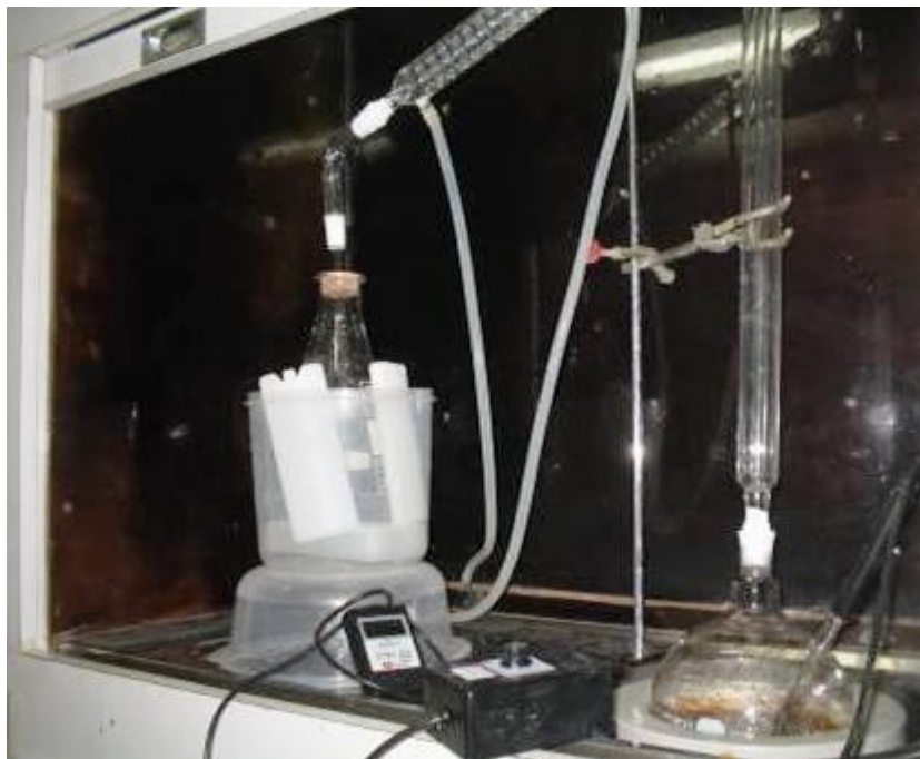
Figura 03: Equipamento utilizado no ensaio de evaporação do Lixiviado em bancada de laboratório
