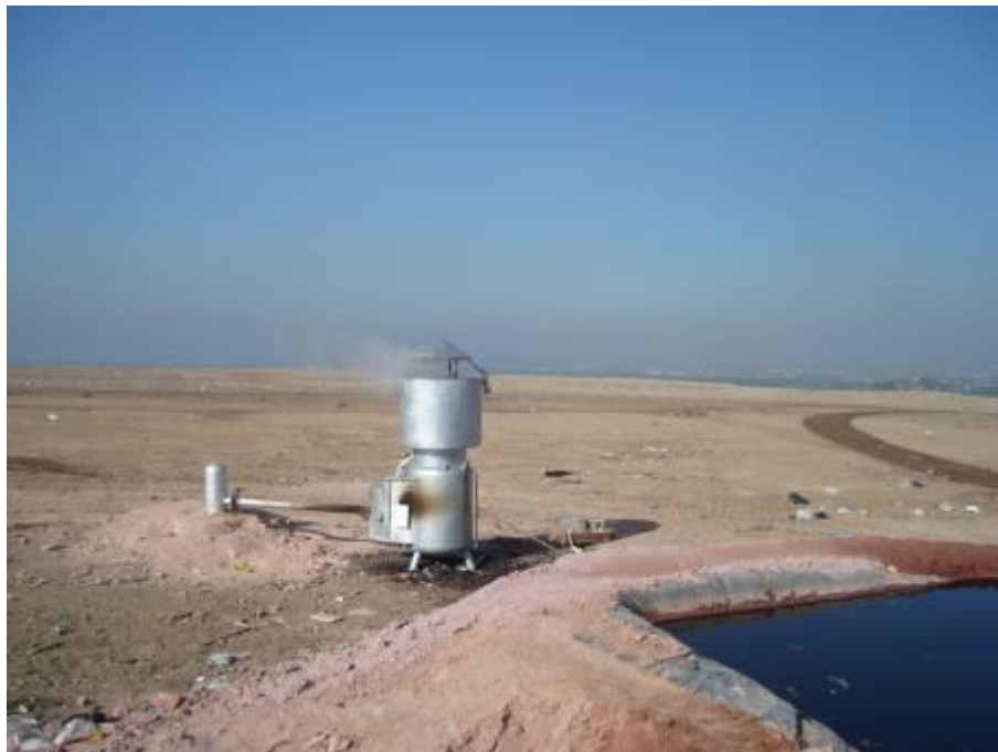
Figura 01: Evaporador Unitário em operação próximo à lagoa de acumulação de lixiviado
